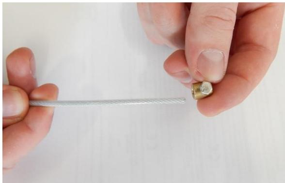
1. Mettre la manche sur le guide câble Photo 1. Dans la pince de câble il faut visser la vis, avec les doigts jusqu'à la résistance, en suite (Photo2) - faire deux tours complets – dépassement tourne la tête de vis
