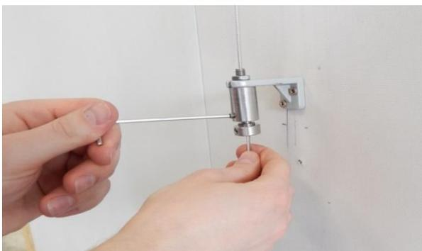
8. Après avoir verrouillé le câble dans le tendeur, desserrez le boulon en verrouillant la partie mobile du tendeur. La vis conique est retirée jusqu'à ce que la partie mobile du tendeur glisse hors de la partie solide et nous la laissons ainsi
