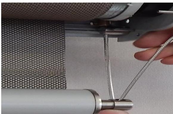
2. Retirez le couvercle d'inspection de la cassette. Faites passer le câble à travers le support de cassette et la tige du capuchon du faisceau inférieur
