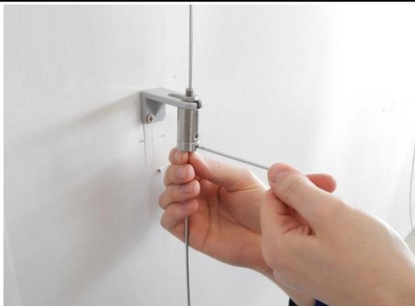
7. Verrouillez le câble dans le tendeur en serrant la vis conique jusqu'à ce que la première résistance soit rencontrée, puis utilisez une clé Allen et faites des tours de 1,25-1,5 tout en vous rappelant de laisser un petit dégagement nécessaire au bon fonctionnement du tendeur. Le dépassement de la plage spécifiée provoque la rupture du filetage, la destruction du siège à vis ou la destruction de la pointe de la clé.
